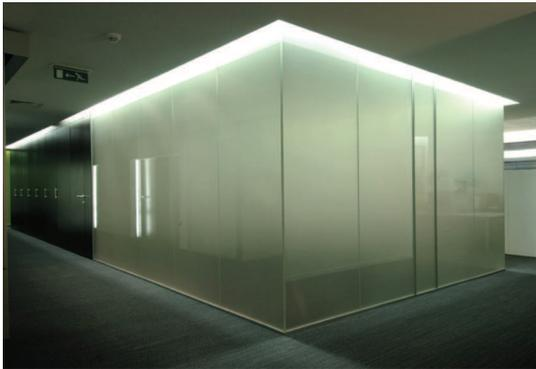
Lorsque les feuilles ne sont soumises à aucune tension électrique, les cristaux liquides encapsulés dans le film LC ne sont pas alignés et leurs positions désordonnées diffusent la lumière dans toutes les directions: le verre est alors opaque. Dès qu'un champ électrique est établi entre les deux couches conductrices déposées sur le film, les cristaux liquides s'orientent et s'alignent: Le verre devient transparent.
